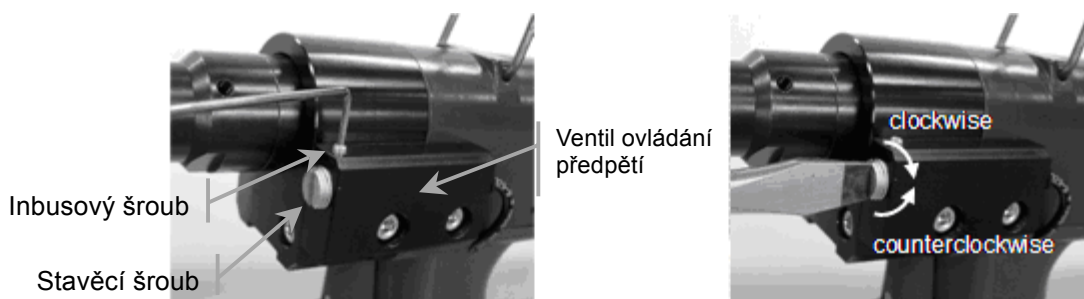
Obrázek 14: Nastavení předpětí
