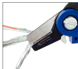
Schneiden der Paarschirmung Cutting the double shielding
