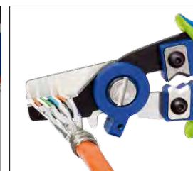
Schneiden der Innenleiter Cutting the conductors
