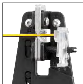
Kabel an Längenanschlag anlegen Position cable at length stop
